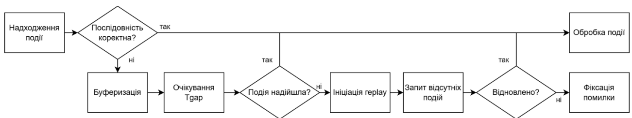
Рис. 2.5. Схема механізму відновлення пропущених станів
